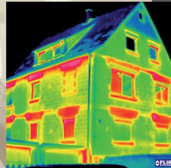
Schluss mit Energieverlust: Durch modernste Techniken wie thermographische Aufnahmen und Luftdichtheits-Prüfungen mittels Unterdruckerzeugung können wir Schwachstellen am Haus sichtbar machen und gezielt beseitigen.
